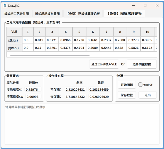
图 6-2 非理想物系理论板图解输入示例
